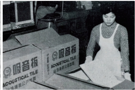
進行吸音板的裝箱作業。(王松雄提供)
